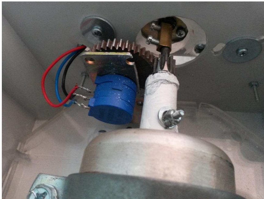
Figura 2 – vista dell' ingranaggio e potenziometro
