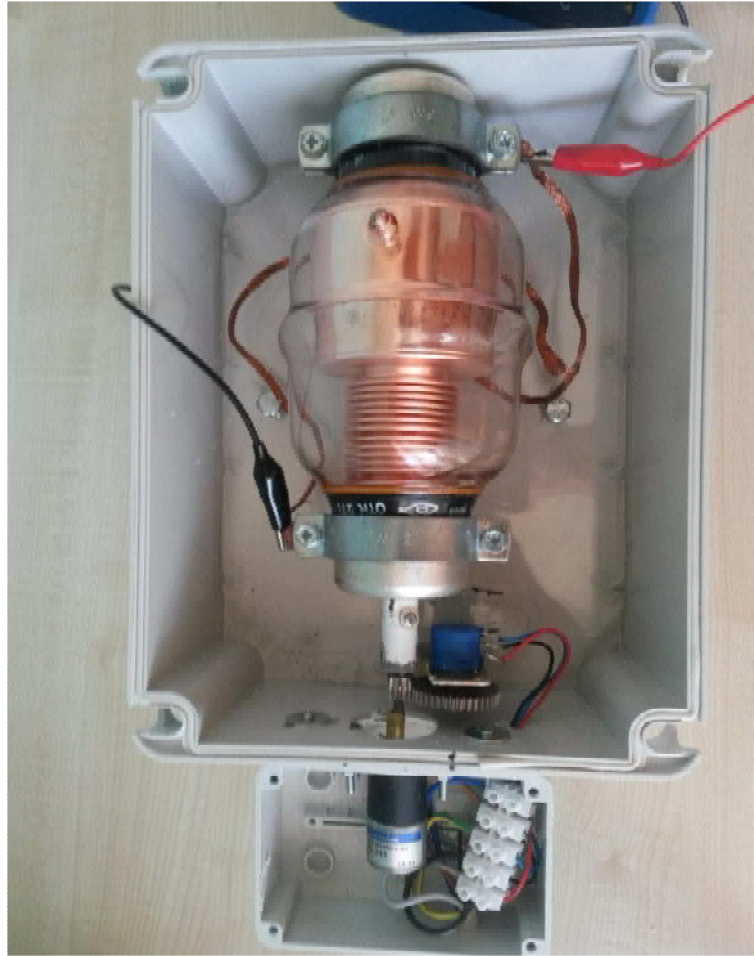
Figura 1 – particolare interno scatola contenente il condensatore e vari componenti.
