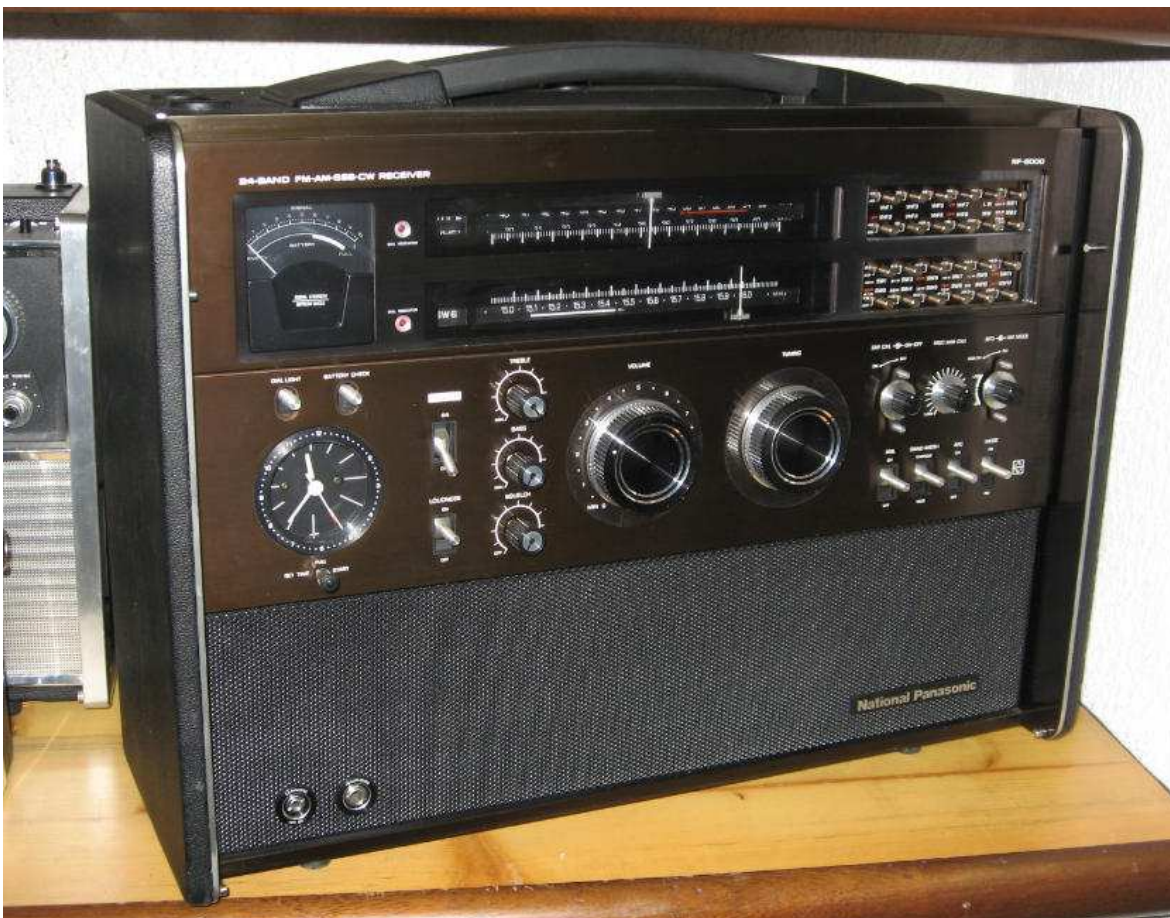
Foto dell'imponente frontale della RF 8000 in alluminio anodizzato color bronzo; al centro del pannello sono visibili le scale parlanti e le pulsantiere dei 2 banchi per la preselezione a motore delle gamme d'onda.
