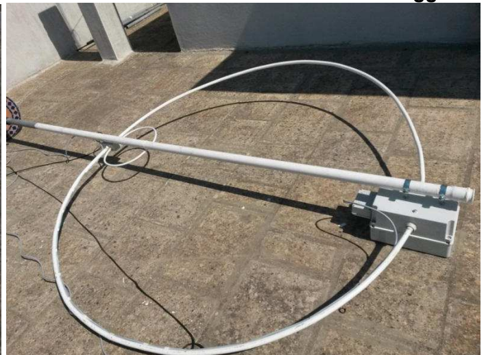
Figura 7 – qui si nota il cavo di controllo nastrato ad un lato dell'anello
