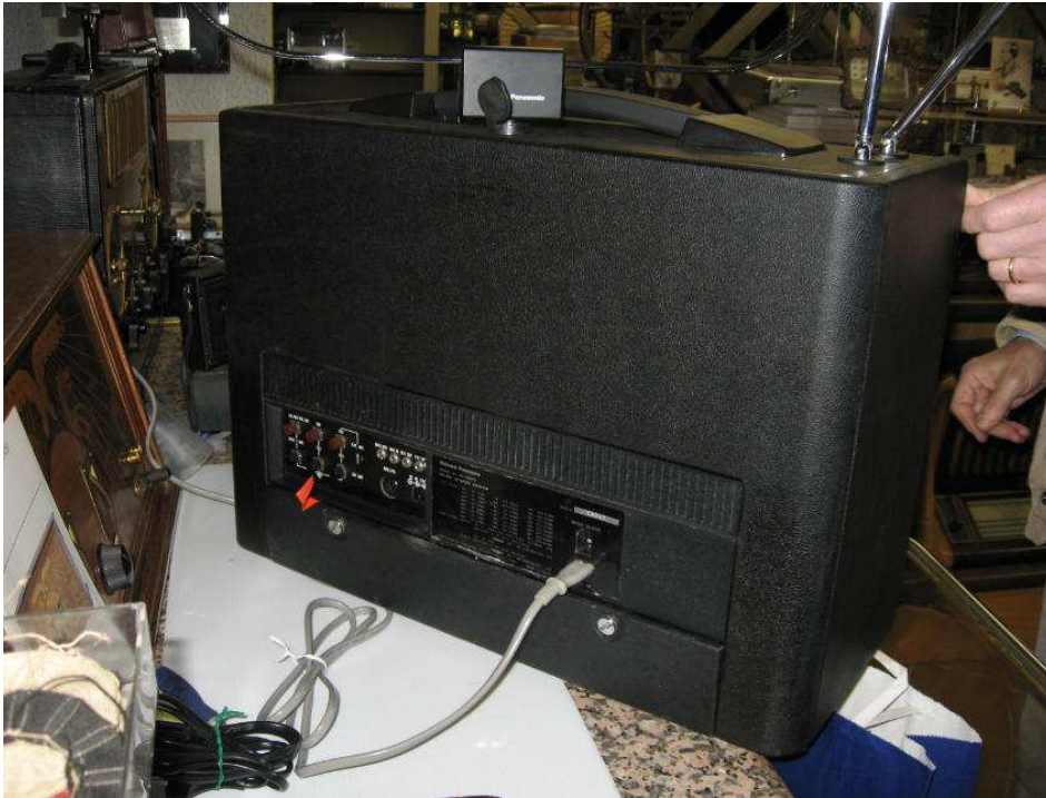
National Panasonic RF 8000 - Vista posteriore con prese per antenne esterne, uscite varie e presa per alimentazione rete.
