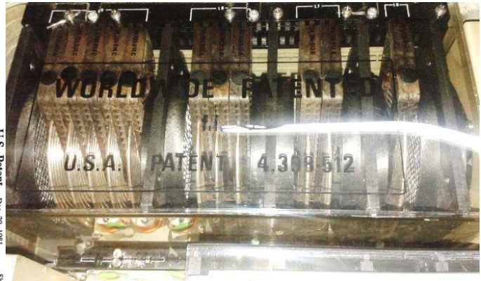
Il pacco induttanze brevettato da Telettra
