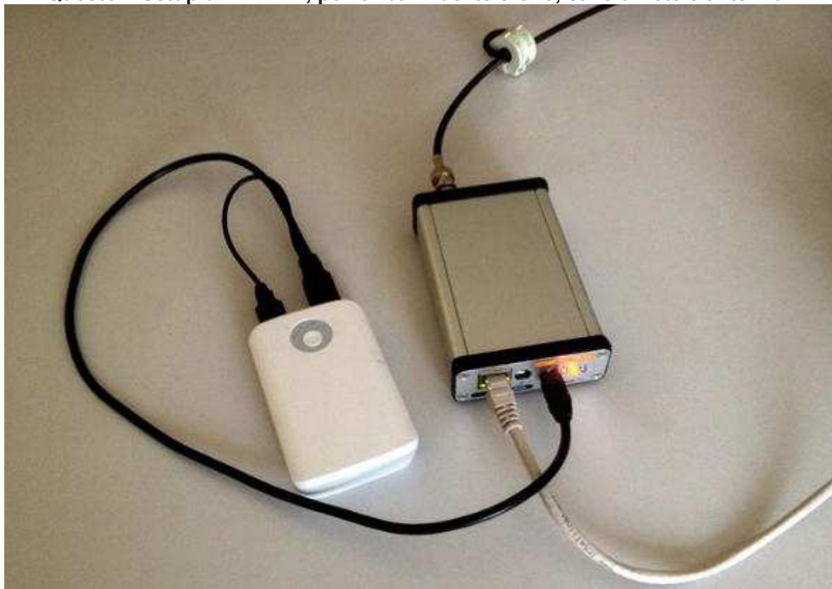
Questo il Setup di AFREDI, power bank del telefono, cavo di rete e antenna
